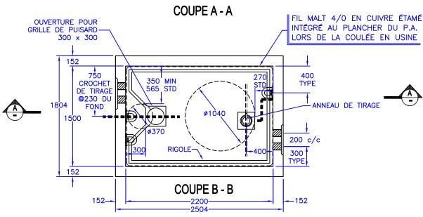
\* Etrier de tirage: position variable selon le nombre de nappe de conduit Béton et acier d'armature rencontrent et/ou excèdent les normes de Hydro-Québec 02-1120, 02-1420, 02-1510 et du devis de performance Hydro-Québec Surface portante: 4.5m<sup>2</sup>
